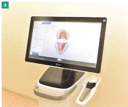
4 新型の歯科用CAD/CAMシステムを取り入れ、患者の負担を軽減
